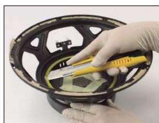
Nettoyer la surface du châssis en enlevant les restes du centreur avec un cutter.
