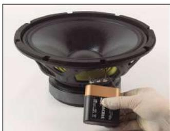
Vérifiez la polarité avec une pile. Connectez la borne positive de la pile à la borne positive du haut-parleur et faites de même avec les bornes négatives. Il convient de vérifier que l'ensemble mobile se déplace vers le haut.
