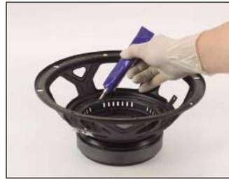
Appliquer la colle contact\* sur les surfaces du châssis qui doivent recevoir le centreur.
