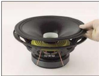
Introduire les cales en plastique à l'intérieur de la bobine et coller l'ensemble mobile en positionnant correctement les tresses devant le bornier du châssis.
