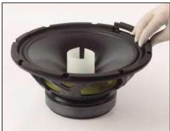
Positionner les segments en veillant à ce que les encoches soient face aux trous de fixation du châssis. Attendez 8 heures. Passer les tresses dans les rivets du bornier en laissant suffisamment de longueur pour permettre au cône de se déplacer sans que les tresses se touchent. Souder les tresses et couper l'excédant.
