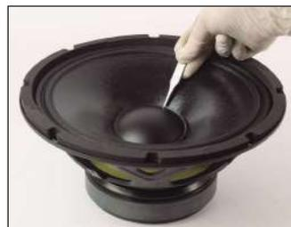
Si le cache poussière n'a pas de rebord, le placer sur la membrane et déposer un cordon de colle à la jonction des deux pièces. Attendre 24 heures.
