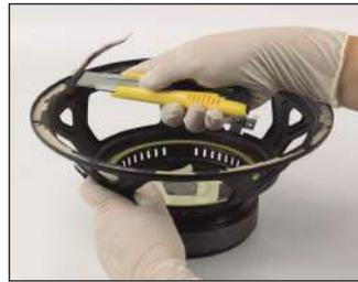
Nettoyer la surface du châssis en enlevant les restes des segments et membrane avec un cutter.
